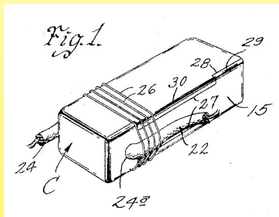
10 ноября 1941 года в Сент-Луисе Лоуренс Ховард подал патентную заявку (США 2,328,342) на миниатюрный термостат для нагревательного одеяла с медленным разрушением, а также на защитный корпус, включающий устройство для защиты от разрыва провода (для компании Knapp Monarch of Saint Louis).
