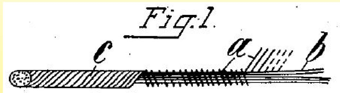
Нагревательный шнур (запатентован Камилем Эрртоттом, 1901 г.). А = нагревательный провод; В = текстильный сердечник; С = внешняя обмотка, намотанная в противоположном направлении от нагревательного провода
