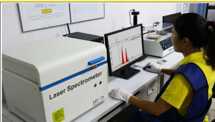
Проводится спектрометрический анализ
