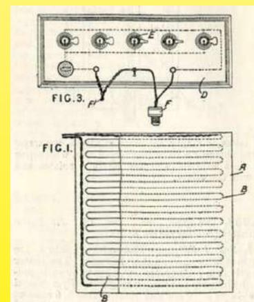
В Англии в 1906 году RF Лафун выдвинул концепцию регулировки мощности путем размещения параллельных сигнальных ламп на резисторах (патент от 13 октября)
