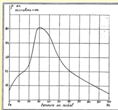
Изменение удельного сопротивления: кривая в зависимости от содержания никеля в ферроникелевых сплавах (La Nature, 1934, Никелевые сплавы и их применение, С215)
