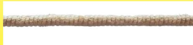
1960 г. Нагревательный шнур Calor, диаметр 1,7 мм, одинарный никель-хромовый нагревательный провод, диаметр 0,08 мм, на слегка скрученном хлопковом сердечнике для предотвращения смятия (коллекция Ultimheat)
