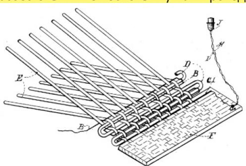
4 июня 1895 года, США. Патент №. 540398, Джон Эмори Мик из Денвера, для компании “Джонс Мэнфэкчуринг Сай” из Нью-Йорка, описал нагревательную ткань, нити основы которой (E) изготовлены из асбеста, а уточные пряди (B) - из проводящего металла, со второй асбестовой прослойкой ткани (D). Два конца нагревательного элемента (F) не включают нагревательный провод.
