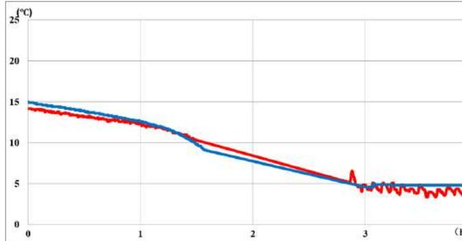
Изменение температуры воды в контейнере, при температуре окружающей среды  $-35^{\circ}\text{C}$ , при нагрузке на поверхность  $0,1 \text{ Вт}/\text{см}^2$  (150 Вт)
