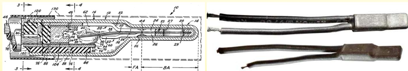
Патентный план 3104296 и прототип серии SL11 (1960, коллекция Ultimheat)
