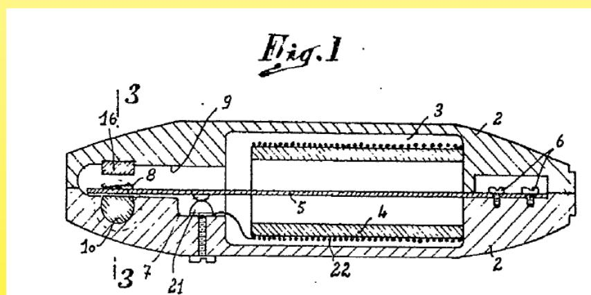
В 1954 году Морис Пьер Маршал, работавший в компании Tisselec, оформил патент на биметаллический выключатель. В данном изделии используется небольшой последовательный резистор (Ном. 22) на нагревательном одеяле, он медленно нагревал биметаллическую полоску (5). Целью данного изобретения было создание таймера нагрева, который автоматически отключает нагрев через определенное время. Маршалу не удалось добиться постепенного управления нагревом, хотя его система очень близко подошла к этой идее.
