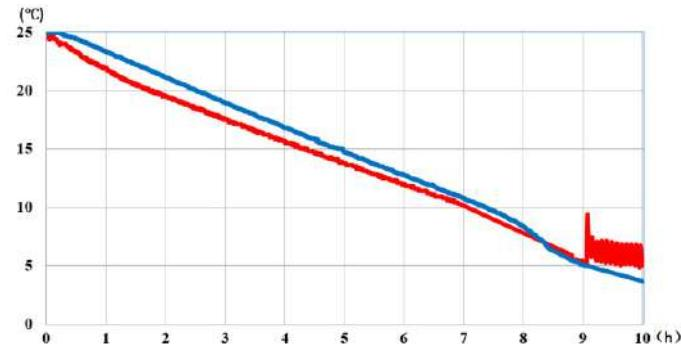
Изменение температуры воды в контейнере, при температуре окружающей среды  $-20^{\circ}\text{C}$ , при нагрузке на поверхность  $0,05 \text{ Вт}/\text{см}^2$  (150 Вт)
