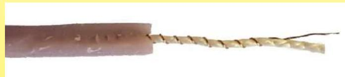
Гибкий нагревательный провод с PVC изоляцией очень маленького диаметра (2 мм), диаметр одной жилы из медного сплава - 0,11 мм (возможно, никель-серебро), она наматывалась на полиэфирную жилу диаметром 0,5 мм, такой провод использовался на нагревательном одеяле General Electric (Англия), примерно в 1962 году. Он является очень горючим. (Коллекция Ultimheat)
