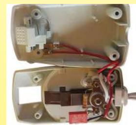
1995: Американское нагревательное одеяло с электросчетчиком, аналогичное разработанному более чем за 50 лет до этого Куком в 1942 году. Внешний вид и вид внутреннего биметалла демонстрирует медленный расцепитель с предполагаемым сопротивлением. Единственным примечательным новшеством в этой модели является наличие фильтра шумоподавления (Коллекция Ultimheat)
