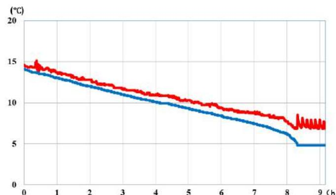
Изменение температуры воды в контейнере, при температуре окружающей среды  $-10^{\circ}\text{C}$ , при нагрузке на поверхность  $0,05 \text{ Вт}/\text{см}^2$  (150 Вт)
