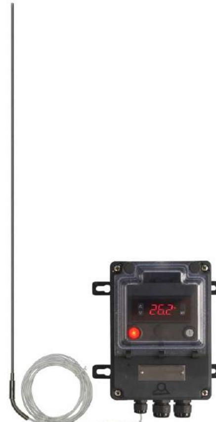
Электронный регулятор температуры, вход для датчика Pt100, автонастройка PID-регулирования. Двойной цифровой дисплей: измеренная температура и заданное значение. Контроль температуры в соответствии с температурой стенок контейнера. **Доступен только с блоком дистанционного управления.** Эта версия, использующая датчик типа Pt100, не взаимозаменяется с моделями нагревателей одеял и рубашек со встроенным датчиком NTC
