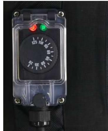
Электронный термостат для датчика NTC. Включение-выключение с предваряющим действием, цифровой дисплей. Прямой монтаж на соединителе нагревателя рубашки или одеяла. Контроль температуры в соответствии с температурой стенок контейнера
