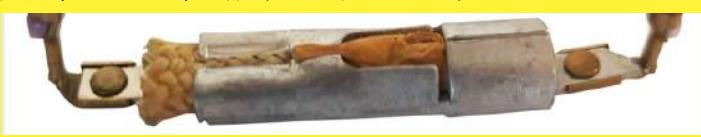
Ограничитель температуры нагревательного одеяла с медленным разрывом, используется в сочетании с английской системой управления мощностью производства GEC (General Electric Company). Он покрыт водонепроницаемой PVC втулкой, приваренной к проводам. Около 1970 года (Коллекция Ultimheat)
