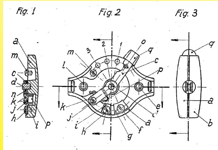
В январе 1943 года парижанин Роже Марсель Күше изобрел 5-позиционный поворотный переключатель,ключающий 3 уровня нагрева, с конструкцией, которая повсеместно использовалась на электрических одеялах в течение более 30 лет. Положение 0 на каждом конце ползунка позволяет пользователю избежать ошибок, особенно в ночное время. (французский патент 890417A)
