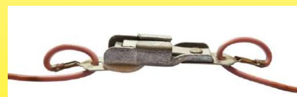
Ограничитель температуры нагревательного одеяла Calor с медленным разрывом, откалибранный на 80°C (около 1960 г.). Обратите внимание на водонепроницаемую PVC втулку, приваренную к проводам, и петлю, сделанную электрическими проводами, проходящими через отверстие в каждой клемме - это сделано для устранения растягивающих напряжений на проводах (коллекция Ultimheat)
