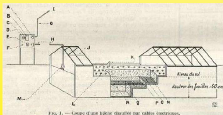
Fig. 1. — Coupe d'une bâche chauffée par câbles électriques.
