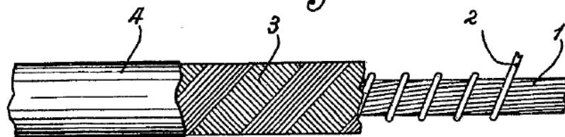
Еще в 1949 году Тисселек подал первый патент на нагревательный шнур, внешняя оболочка которого (3) была покрыта резиной, рвс или эластомером полиэтиленового типа (4) для улучшения изоляции, особенно в тех случаях, когда оболочка была влажной. (Патент FR 982675 зарегистрирован 13 июня 1951 года)
