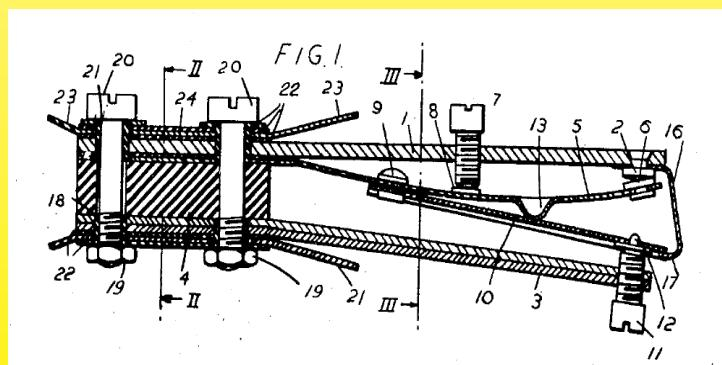
1944 Ограничитель быстрого отключения Thermega для нагревательных одеял
