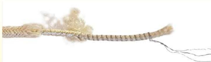
1962 г. Нагревательный шнур марки Jidé. Пришитый непосредственно к одной из сторон греющего одеяла, уже не между двумя тканями, он имеет четыре спиральных никелевых проводника на хлопковом сердечнике, которые затем покрыты очень тонкой обмоткой, а затем хлопковой оплеткой. Он не является водонепроницаемым и очень огнеопасен.
