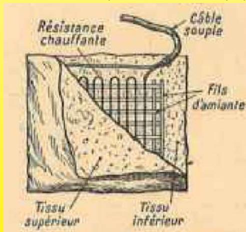
Следующий отрывок о персональном отоплении относится к 1932 году: Нагреваемые ткани в виде ковров, тапочек, одеял, трикотажа, курток, ... где нагревательное сопротивление (50 ватт) изолировано двумя асбестовыми проводами, вплетенными между двумя слоями ткани (1932 Болл, Электричество в городе и сельской местности)
