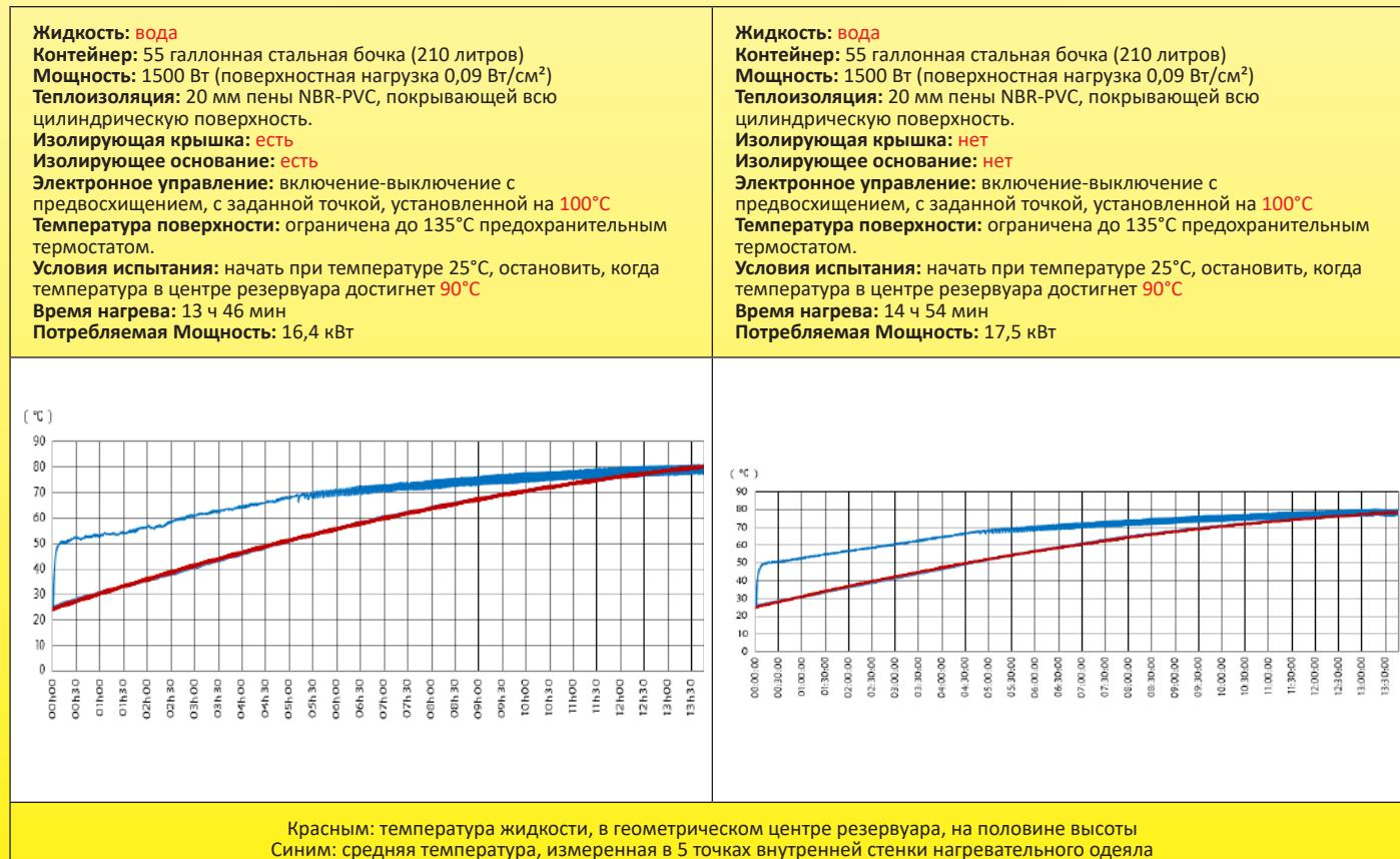
**Анализ результатов:** использование изолирующей подставки и изолирующей крышки сокращает время нагрева на 1 час 8 минут и потребление на 1,1 кВт, т.е. на 6,3%.
