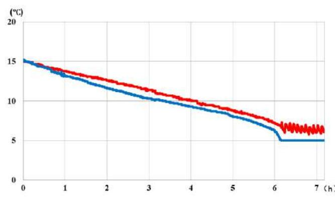
Изменение температуры воды в контейнере, при температуре окружающей среды  $-15^{\circ}\text{C}$ , при нагрузке на поверхность  $0,05 \text{ Вт}/\text{см}^2$  (150 Вт)
