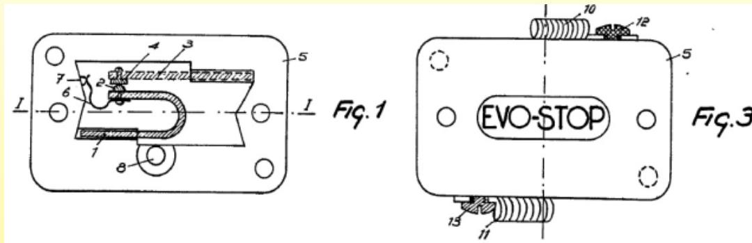
В 1957 году Морис Жорж Мойсе Жервэзо, производитель термопластов (проспект Жоржа Дюрана, 151, Ле-Ман), разработал компактный биметаллический термостат под торговой маркой Evo-Stop в закрытом корпусе с улучшенным медленным прерывателем, чтобы преодолеть проблему радиопомех, и предназначенный специально для подогрева одеял. (Патент 1169253)
