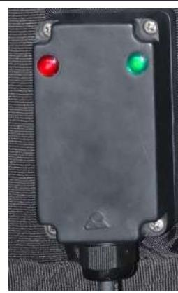
Механический комнатный термостат с фиксированной температурой, встроенный в крышку соединительной коробки. Автоматическое включение обогрева при понижении температуры ниже 5°C, с пилотными лампочками, указывающими на включение питания и обогрева.
