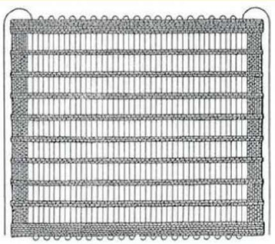
Нагревательная ткань с асбестовой цепью, используемая при температуре до 450°C (1950 Омвatt)
