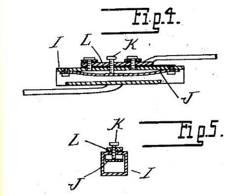
1912 Биметаллический термостат Хоффмана для согревающего одеяла (патент США 1096916). J представляет собой биметаллическую лопатку, заклепанную с обоими концов. Электрический контакт должен размыкаться между лопастью J, деформирующейся при повышении температуры, и установочным винтом K
