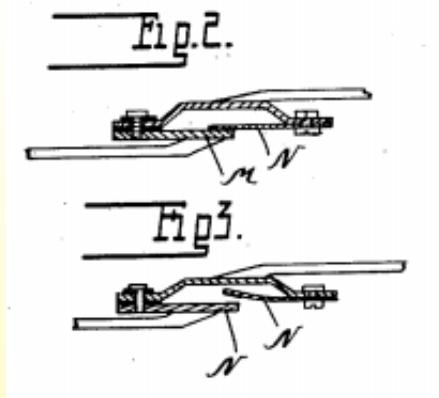
1912 Ограничитель из легкоплавкого сплава Хоффмана для нагревательного одеяла (патент США 1096916).
