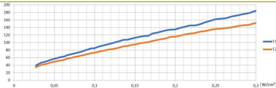
Температура поверхности,  $^{\circ}\text{C}$ , в окружающей среде при  $20^{\circ}\text{C}$  для нагревательных проводов с металлической защитной оплеткой, для различных значений поверхностной ваттной плотности нагревательного одеяла или нагревателя рубашки.
