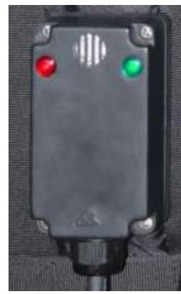
Электронный термостат для датчика NTC. Включение-выключение с предваряющим действием, регулировка с помощью ручки, с пилотными лампочками, указывающими на включение питания и нагрев.
